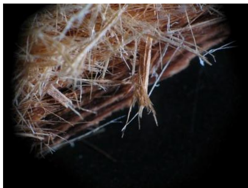
fot.11. Uszkodzenia struktury drewna
