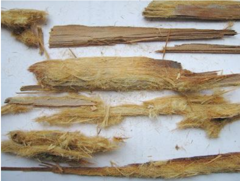
fol.14. Próbkki uszkodzonego drewna, przekazane do badań laboratoryjnych.
