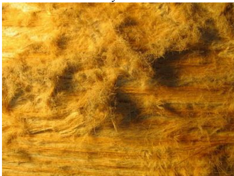
fot.8. Uszkodzone włókna tworzą na powierzchni większe „klaczki”
