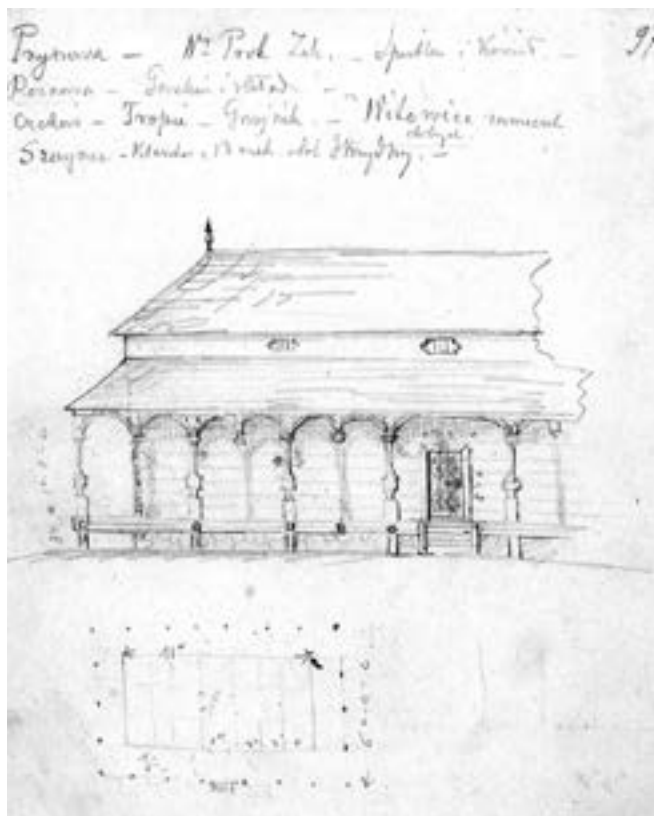
■ Przyszowa – dawny drewniany lamus dworski (zburzony w początkach wieku XX), widok elewacji wschodniej (?), poniżej zwymiarowany rzut poziomy. Rys. A.Gebauera z roku ok. 1900
